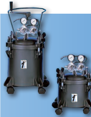
APC04A - 10L APC05A - 20 L - Cuve acier - Ext. : galvanisé - Int. : Téflon - Sortie haute - Pression 3 bars
